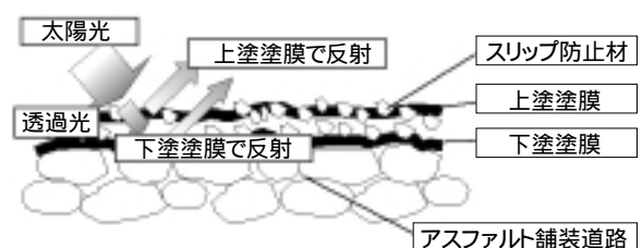
図5 遮熱舗装用塗料の反射機構
