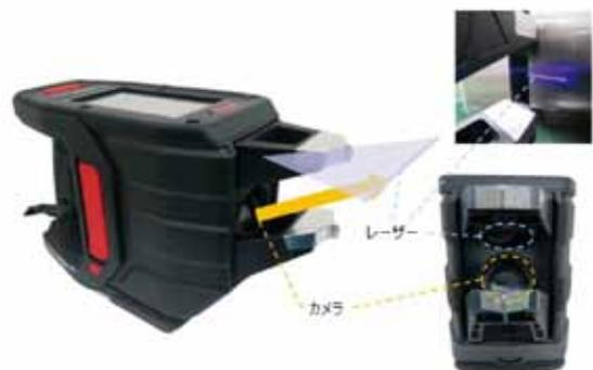
Figure2 GD-PROBER™のレーザーとカメラ
