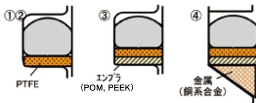
超高压用バックアップリング構成の機能メカニズム
