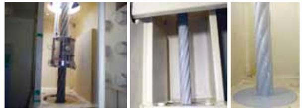
Figure9 ワイヤー表面の形状に合わせた、浸漬装置を開発した外面被覆防錆工法(当社特許技術)
