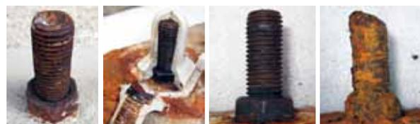
Figure14 試験状況 防錆塗布あり 塗布なし
