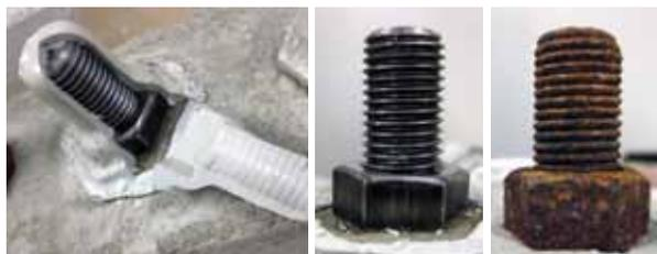
Figure13 試験状況 防錆塗布あり 塗布なし
