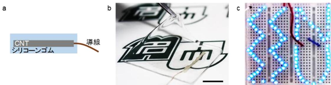
図 1 a. 発電シートの模式図 b. 発電シートの写真（スケールバーは 1 cm）
