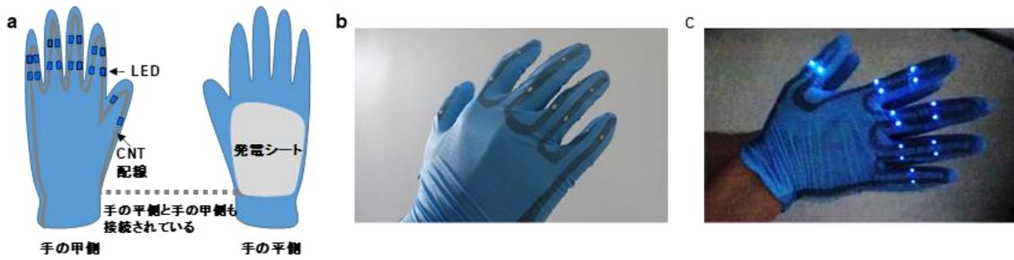
図3 a. 手袋型発光デバイスの概要図 b. 実際の写真
