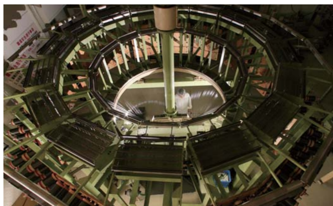
三軸織物の製造機械。一般的な織機とはまるで別物です。
